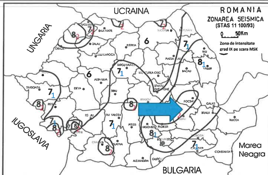
Fig. 7 – Zonarea Teritoriului din punct de vedere seismic
