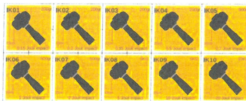
Figura. 6.2 - Gradele de protecție IK
