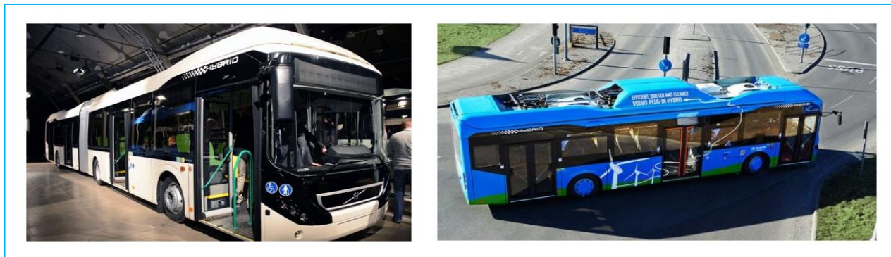
Figură 67 - Autobuzul Volvo 7900 Hybrid (PHEV) cu posibilitate de încărcare a bateriilor
