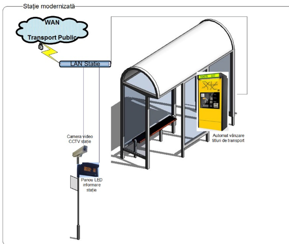
Figură 10 - Sistemul de echipamente instalat în stațiile modernizate
