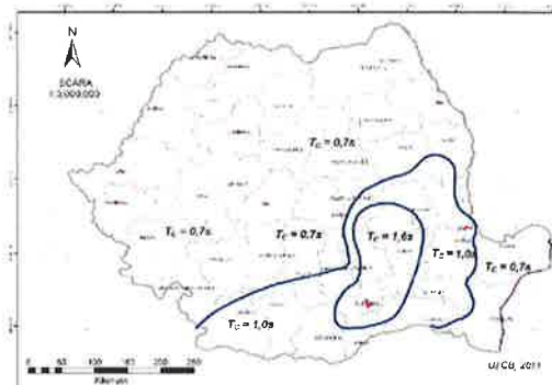
Figura 2 - Zonarea teritoriului României în termeni de perioada de control (colț), TC a spectrului de raspuns.
