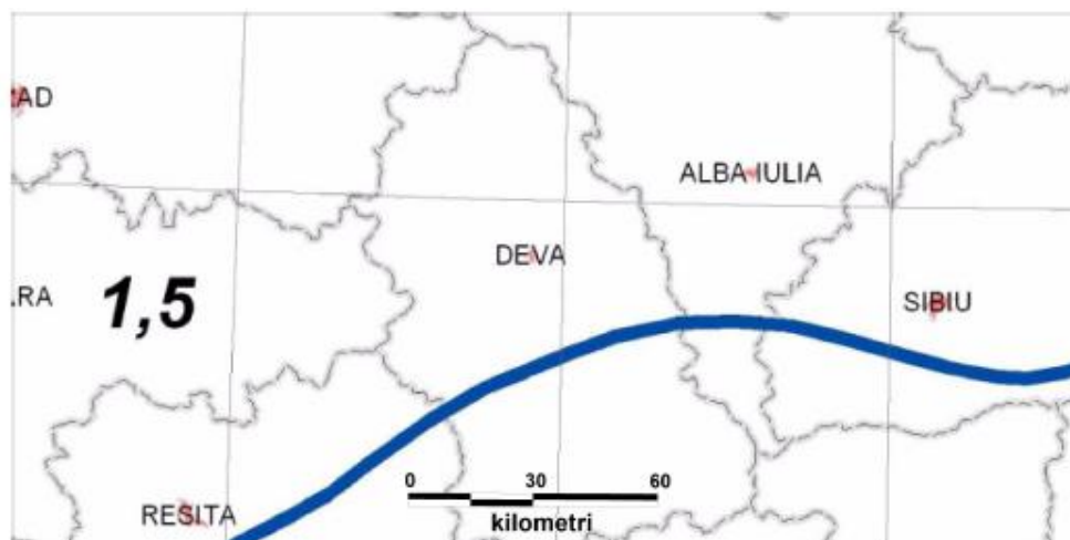
Figura 5 – Evaluarea acțiunii zăpezii asupra construcțiilor
