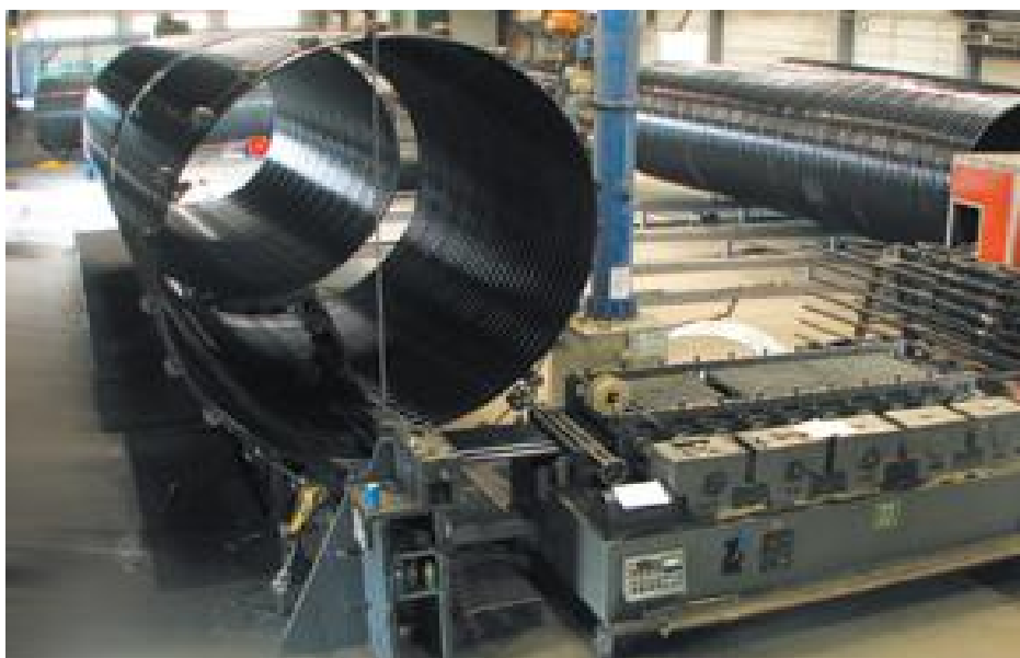
[fig. 1] Structură metalică din oțel ondulat realizată prin laminare la rece
