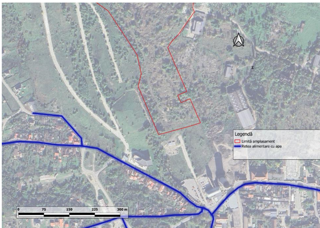
Figura 15 – Localizarea rețelelor de apă în raport cu amplasamentul Corvinia
