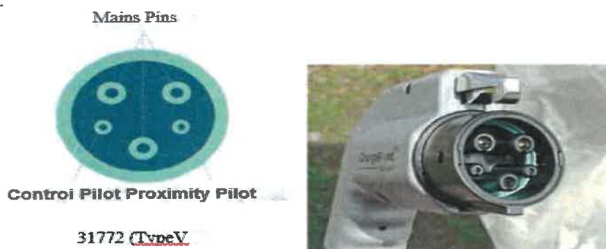
Figura 9 - Mufa EV tip „Type 1” și configurația conectorilor
