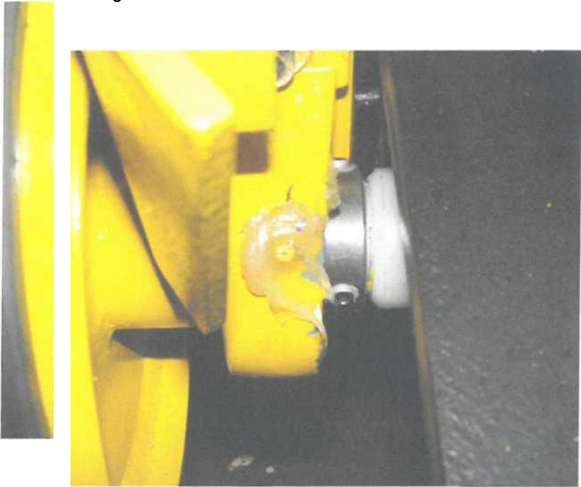
Figura 7: loc ungere antrenare banda
