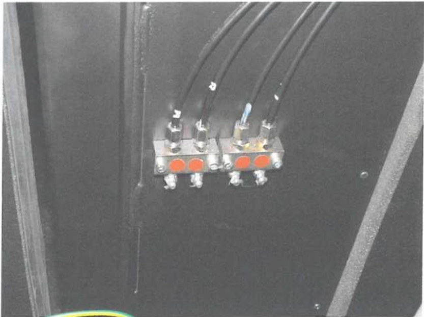
Figura 12: niplu ungere centrala motor electric
