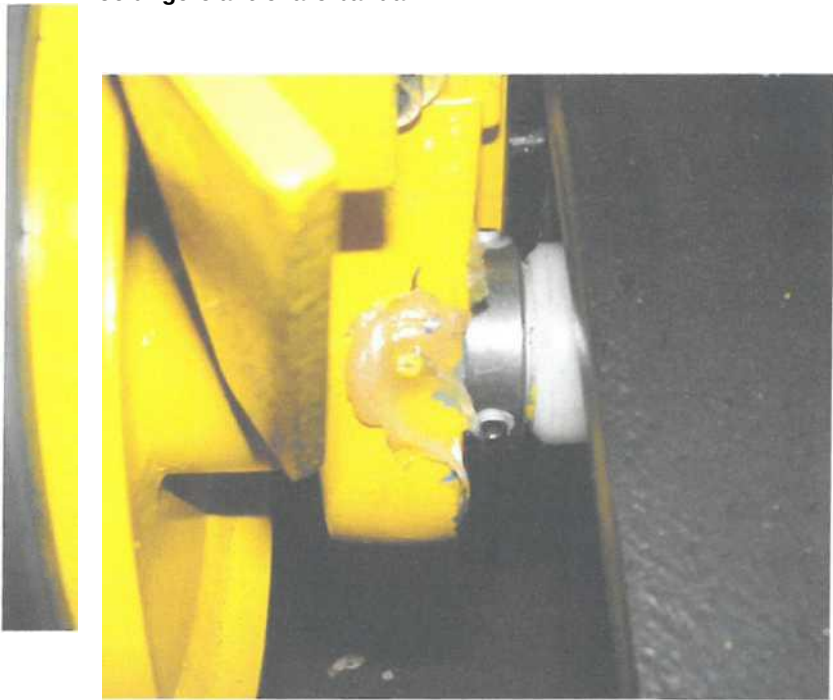
Figura 7: loc ungere antrenare banda
