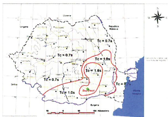
Zonarea teritoriului României în termeni de perioada de control (colț), T_c a spectrului de răspuns
