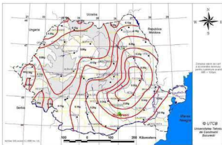
Zonarea teritoriului Romaniei in termeni de valori de vârf ale accelerației terenului pentru proiectare a_g pentru cutremure avand intervalul mediu de recurență IMR = 100 ani.
