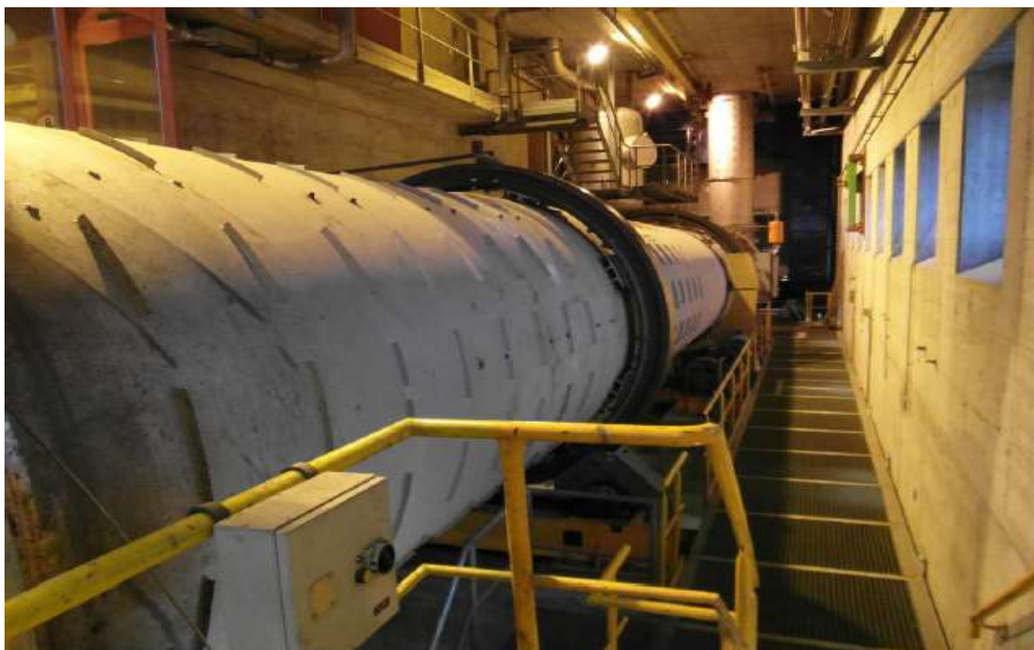
Figura 6-12 - Cuptor rotativ pentru piroliza si post-combustie (ERZO Entsorgung Region Zofingen, CH-4665 Oftringen, https://www.erzo.ch/ )
