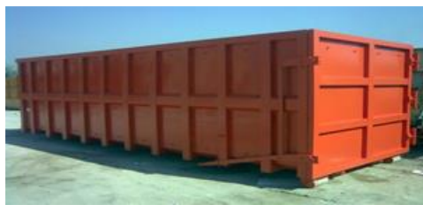
Figură 3-1 – Container de transport fără compactare (exemplu)
