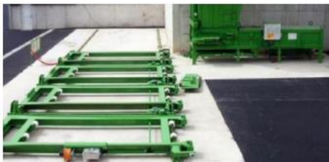
Figură 3-60 Exemplu presă fixă pentru container cu sistem automat de schimbare a containerelor
