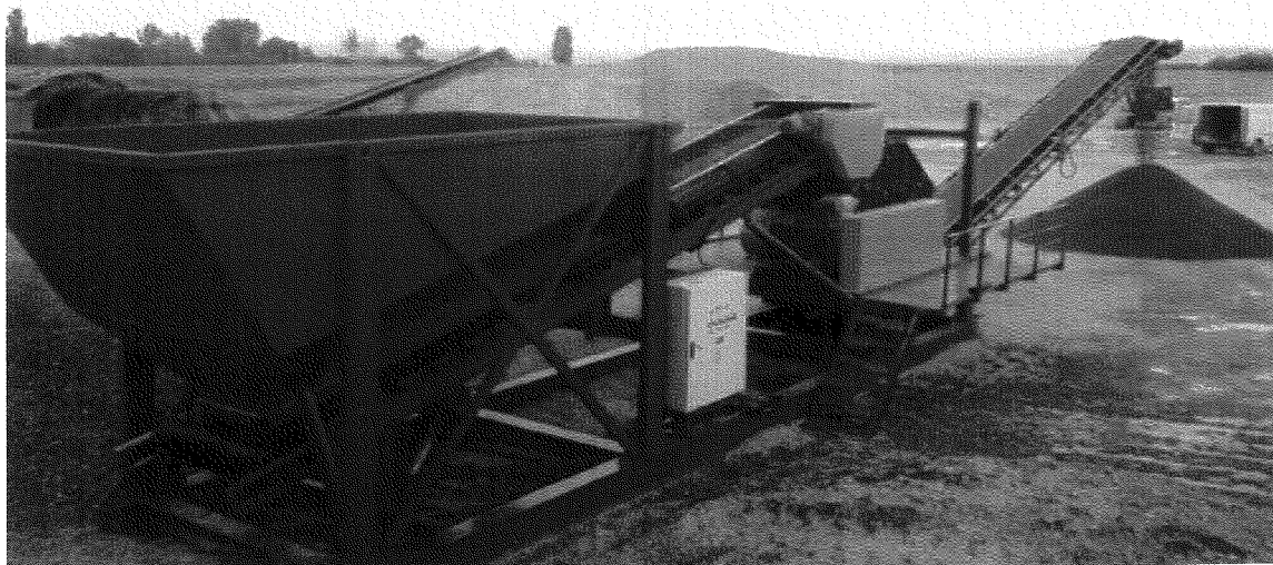
Fig. nr. 5 Instalații fixe de tratare a deșeurilor din construcții și demolări
