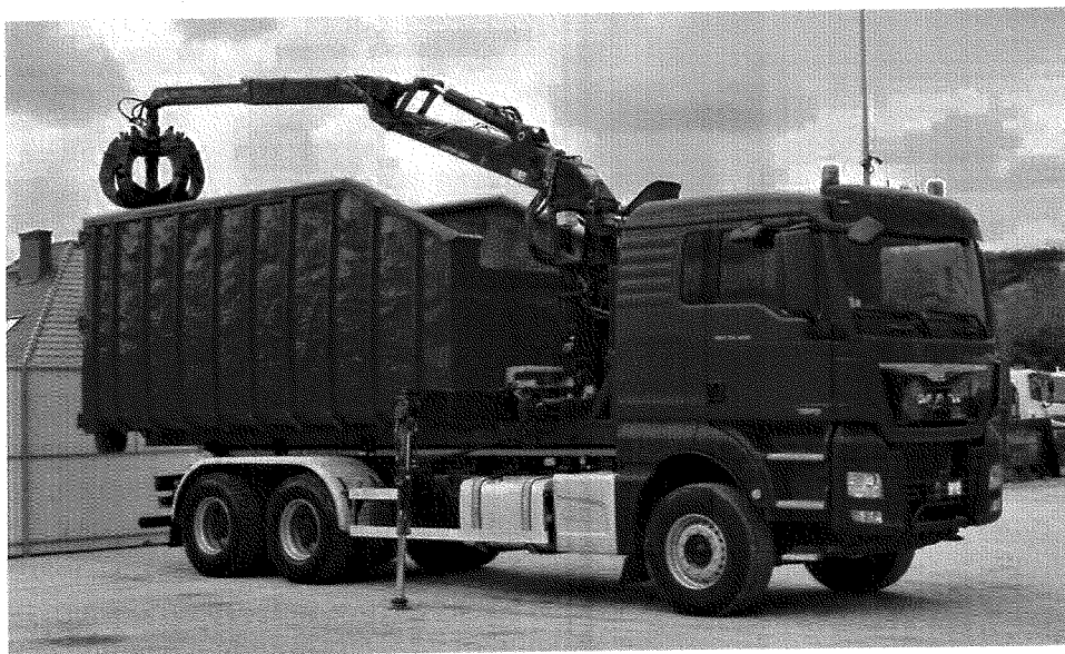
Fig. nr. 4 Autospecială transport cu posibilitate de încărcare a deșeurilor
