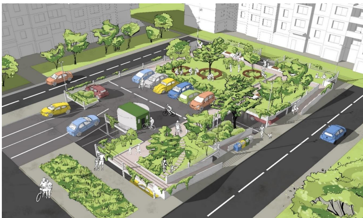
Figură 6-15 Mod de amenajare parcare 2 nivele cu nivelul superior axat pe spațiu verde și locuri de parcare vizitatori
