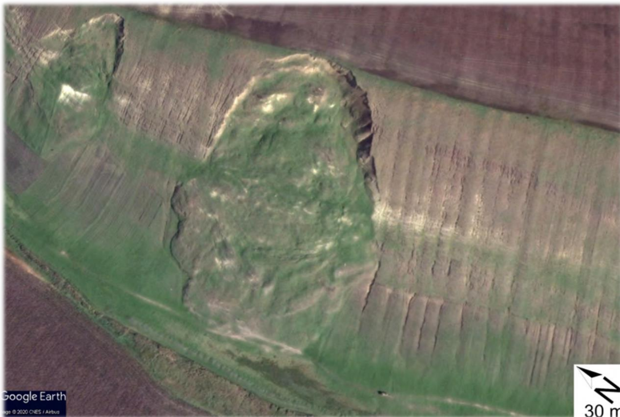
Fig. nr. 3- Alunecare rotațională pe valea Petroșița, sursa: https://www.google.ro/maps
